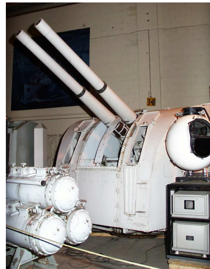
Galerie n° 4 : Canons bitubes à tir courbe de 4 po montés sur tourelle. MCG 18770068-001
